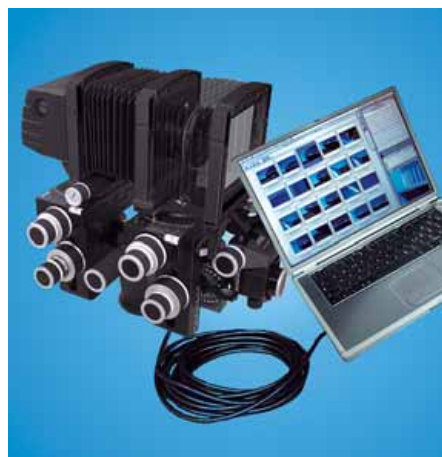
Een compact digitaal high-end systeem met één enkele kabel voor zowel voeding als datatransfer.
